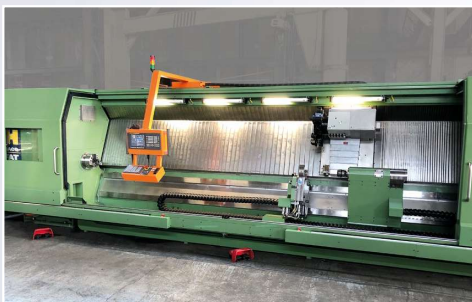
FCT700 - długość toczenia 5.100 mm. Automatyczne drzwi. Niezależny napęd NC konika i podtrzymki hydraulicznej. Głowica rewolwerowa z napędzanymi narzędziami.
