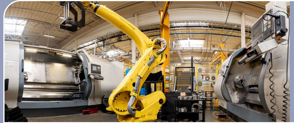
Dwie maszyny FCT700 x 2100 współpracujące ze zintegrowanym robotem
