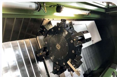
FCT700 - długość toczenia 5.100 mm. Automatyczne drzwi. Niezależny napęd NC konika i podtrzymki hydraulicznej. Głowica rewolwerowa z napędzanymi narzędziami.
