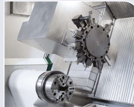
Głowica narzędziowa z promieniowymi gniazdami napędzanych narzędzi oraz zintegrowaną osią Y
