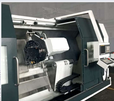
FCT 700 x 1600 z 12 pozycyjną głowicą narzędziową ze zintegrowaną osią Y
