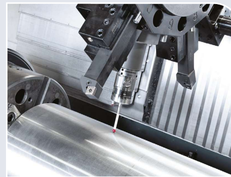
Sonda pomiaru detalu zamontowana w gnieździe głowicy
