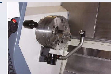
Manualny, dodatkowy system pomiaru narzędzia
