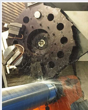
Głowica ze specjalną tarczą z osiowymi i promieniowymi gniazdami dla napędzanych i stałych narzędzi
