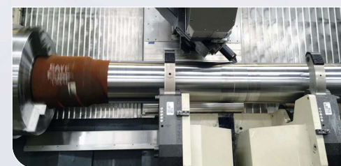
Podrzymki hydrauliczne z niezależnym sterowaniem numerycznym
