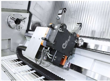
Samocentrująca podpora hydrauliczna. Może być wyposażona we własny napęd.
