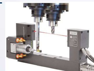
Podwójny system pomiaru narzędzi: sonda laserowa do pomiaru napędzanych narzędzi oraz sonda dotykowa do narzędzi statycznych
