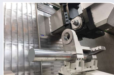
Przystawka wycaczadła montowana na głowicy z osią B. Parking na przeciw-wrzecionie ułatwiający szybki montaż.
