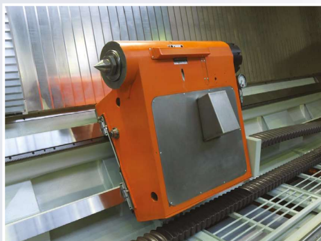
Konik hydrauliczny z automatycznym zaciskiem do łoża. Może być wyposażony w osobny napęd NC
