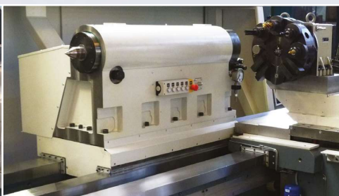
Przejazd suportu bez kolizji z konikiem
