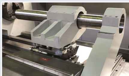
Oprawka wytaczadła z systemem płyt szybkozmiennych
