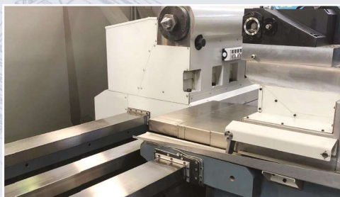
Przejazd suportu bez kolizji z konikiem
