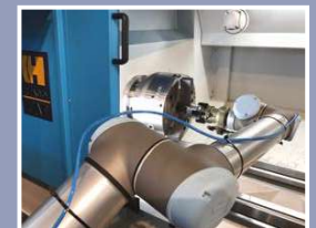
Hydraulisches Futter in Zusammenarbeit mit einem Roboter
