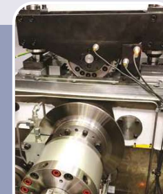
Spindelstock mit interpolierender C-Achse und mit einem Hydraulikzylinder
