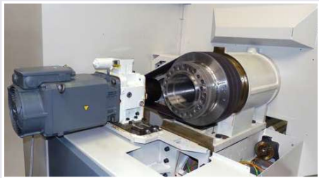
Direkter Spindeltrieb über 2-Stufen-Planetengetriebe.
