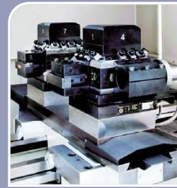
Zwei 4-Positionen Kopfrevolver als Tandem
