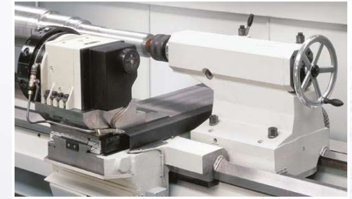
Die Reitstockpinole mit einem Durchmesser von 125 mm, eingebettet in einem langgestreckten Körper, ermöglicht eine größere Ausladung bei gleichzeitiger Beibehaltung der Bearbeitungssteifigkeit. Für die Bearbeitung schwerer Werkstücke kann der Pinolendurchmesser auf 140 mm oder 160 mm erhöht werden. Als zusätzliche Option gibt es eine Lagerbuchse, geeignet für die Montage eines festen Körnerspitze auf einem Kegel MK5 oder MK6
