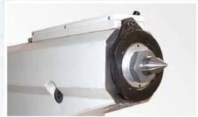
Spezielle Konstruktion eines Reitstocks mit einer 160mm-Pinole, durch welche die Steifigkeit der Maschine und das maximale Gewicht des Werkstücks erhöht wird.
