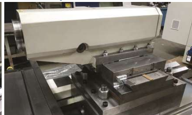
Spezielle Konstruktion eines Reitstocks mit einer 160mm-Pinole, durch welche die Steifigkeit der Maschine und das maximale Gewicht des Werkstücks erhöht wird.
